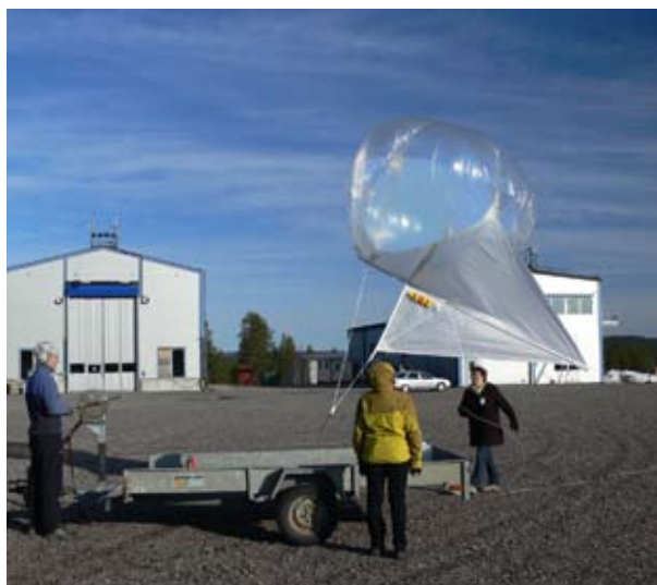
Fig. 2.1.1 Testflygning av en "helikite" (en markbunden ballong) — ett nytt sätt att göra in-situ mätningar av atmosfärsp parametrar vid höjder upp till 2000 m. (Bild: Maria Mihalikova, IRF)
