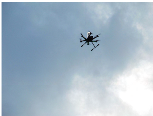
Fig. 2.1.1 Programmet har använt en drönare för att utföra mätningar av temperaturprofil i atmosfären över Kiruna. (Bild: Sheila Kirkwood, IRF)
