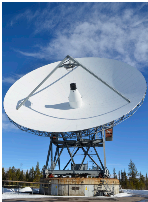
Fig. 2.1.1 EISCAT:s radarantenn i Kiruna ingår i ett system som används av STAR:s forskare för att studera jonosfären, meteoror och polar-mesosfäriska vinterekon (PMWE). (Bild: Annelie Klint Nilsson, IRF)
