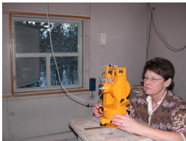
Fig. 4.2 Maj-Britt Hammarström utför absolutkalibrering av magnetometern i Kiruna genom att mäta magnetfältets riktning i horisontell- och vertikal led med en speciellt modifierad teodolit. (Bild: IRF)
