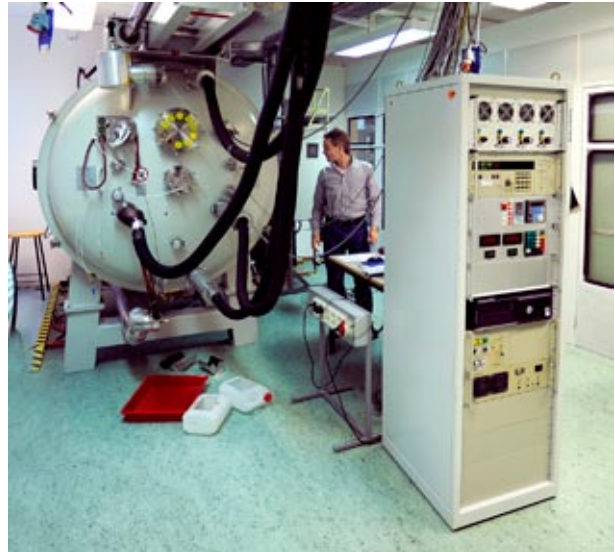
Fig. 1.1 Bland IRF:s testanläggningar i Kiruna finns en rymdsimulator där man kan simulera i synnerhet de termiska förhållanden som råder ute i rymden. (Bild: Torbjörn Lövgren, IRF)
