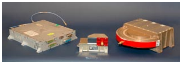
Fig. 2.3.3 Instrumentet SARA (fr. v. huvudenheten, SWIM och CENA) gick in i bana kring månen den 8 november 2008 ombord på den indiska satelliten Chandrayaan-1. (Bild: IRF)
