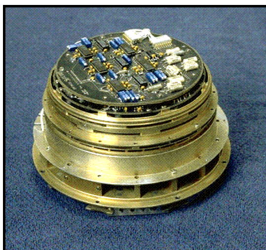
Experiment för energirika neutrala atomer, ENA, framtaget vid IRF för Mars-96.
