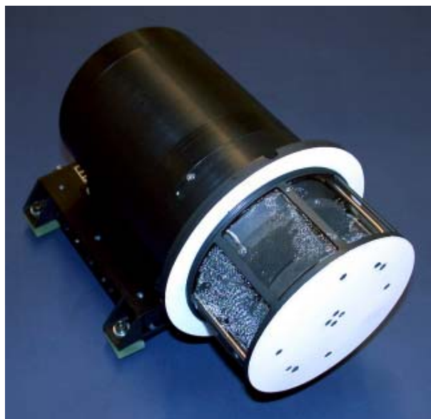
Fig. 2.3.1 Under 2002 levererade programmet instrumentet ICA (Ion Composition Analyser) som ska flyga på ESA:s rymdfarkost Rosetta för att studera en komet.
