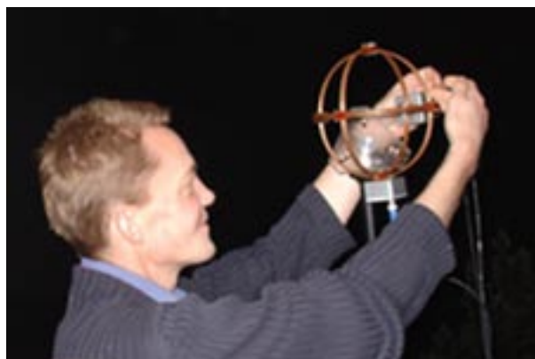
Fig. 2.5.1 Det patenterade treaxiella antensystem som ingår i det mätinstrument för såväl satellitburna som markbundna mätningar som utvecklats inom programmet.
