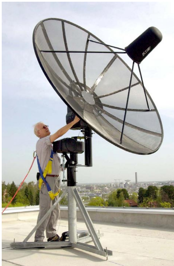
Fig. 2.5.1 Tekniker Harley Thomas installerar ett enkelt radioteleskop på taket av Ångströmlaboratoriet i Uppsala. Teleskopet är optimerat för observationer av väteatomernas radiostrålning på 1420 MHz (21 cm våglängd). (Foto: Teddy Thörnlund).
